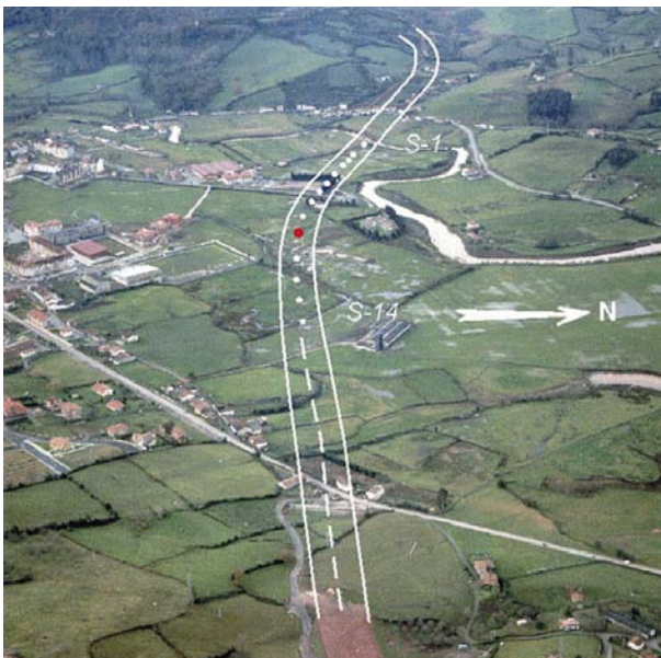
Figura 107. Vista aérea del estuario de la ría de Villaviciosa con el trazado de la autopista del Cantábrico. Los puntos marcan la posición de los 14 sondeos. El punto rojo indica el analizado en este estudio
