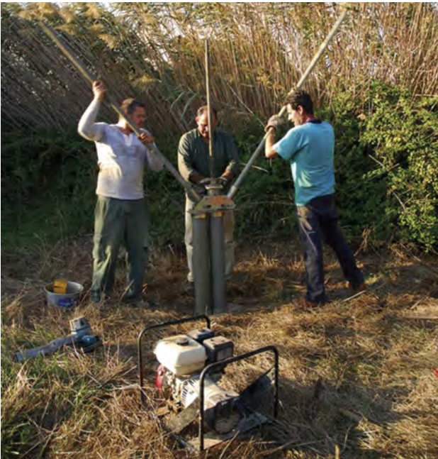
Figura 733. Trabajos con equipo portátil durante una de las campañas de sondeo en las Islas Baleares
