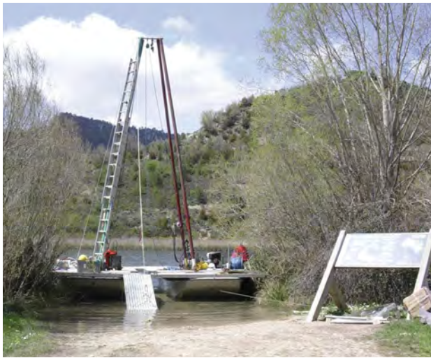
Figura 629. Plataforma de sondeos con pistón Kulleberg del LRC en la laguna de Taravilla
